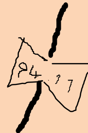
Pásek neporušený, trhlina je v klidu
