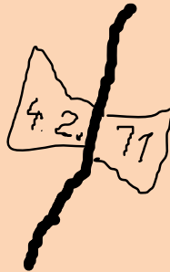
Pásek porušený bez posunutí
